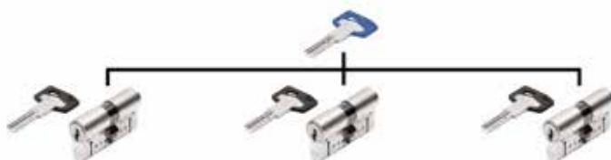
**GMK= è un impianto a più livelli,** in cui, oltre alle chiavi di ogni singola porta e alle chiavi maestre che aprono gruppi di cilindri, esiste una chiave maestra superiore a cui fa riferimento tutto il sistema. Questo impianto è particolarmente indicato per le strutture ad apertura gerarchica, dove per esempio il direttore può accedere a tutti i locali, mentre i dipendenti ai locali prestabiliti.
